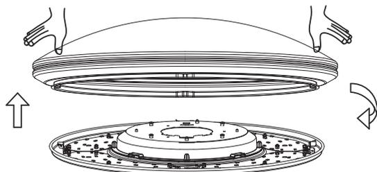
■カバーを反時計回りへ回し、カバーを外します。
