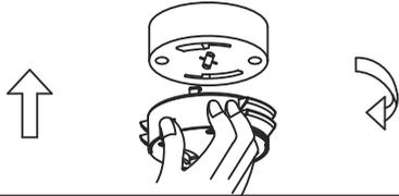
③ローゼットアダプターをローゼットに差込み、時計方向へ回転し固定する
