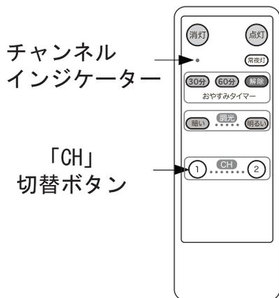
■リモコンのチャンネルを、操作したい本体のチャンネルに合わせます。「CH1」または、「CH2」ボタンを3秒間以上押し続けると、押されたチャンネルボタンのチャンネルが設定されます。
