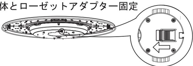
■ ローゼットアダプターの緑のスライドスイッチをロックの位置(矢印の方向)にし、本体とローゼットアダプターを固定する
