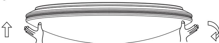
■ カバーを本体の溝に合わせ、カバーを時計回りへ回し、固定する
